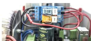
Dispositivo per la discesa automatica in caso di mancanza di corrente (accessorio fornito premontato).
